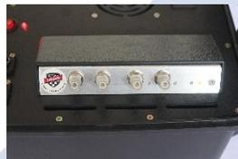
Pode-se observar os leds de cada conector do reader piscando, quando isso ocorrer, o **SmartReader** estará em operação e hábil para leituras de chips se as antenas estiverem conectadas.
