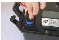
Se deseja carregar a bateria externa também, basta conectar a bateria externa no outro conector de energia. A ordem dos conectores é indiferente para carregador ou bateria externa.
