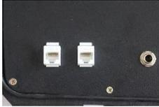
O **SmartReader** possui dois conectores para se fazer uma conexão ethernet, pode-se usar qualquer um deles.
