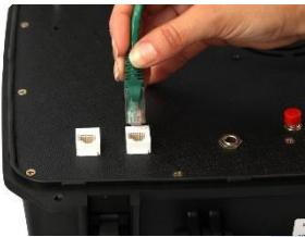
O **SmartReader** possui dois conectores RJ45 para realizar conexão Ethernet. Pode-se usar qualquer um deles para se conectar ao computador.
